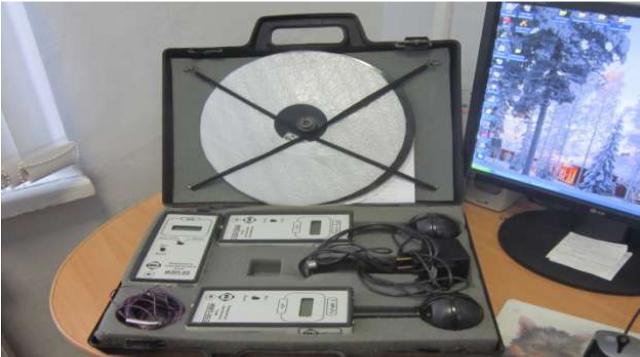
«Циклон». Измеряет электромагнитные поля от компьютера.
