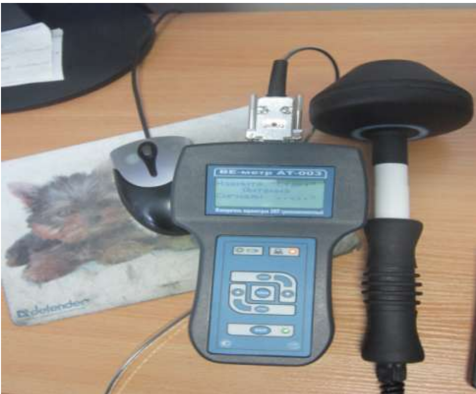
Ве-метр АТ-003. Измеряет электромагнитные поля от компьютера (фоновые замеры). Выполняет функции сразу трех предыдущих приборов.
