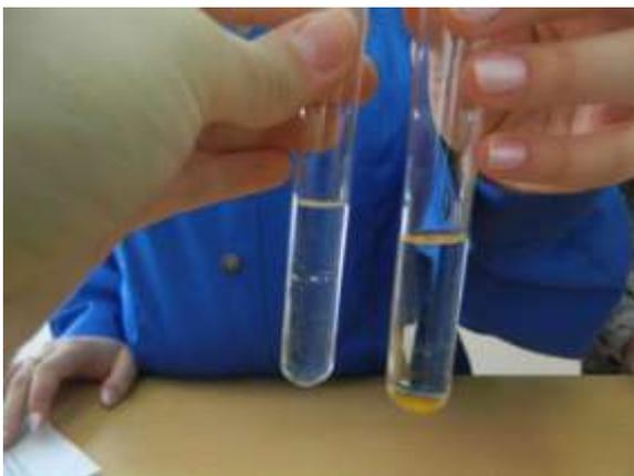
Рисунок 8. Определение наличия воды в бензине
