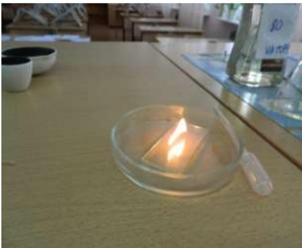
Рисунок 2. Определение фактических смол в бензине
